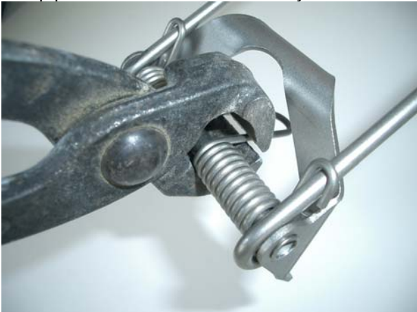
2. Feder mit Kneifzange nach unten spannen 2. clamp the spring by use of a pincer
