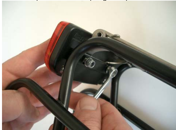
5. montieren Sie nun das Rücklicht /Reflektor 5. now mount the rear-light/reflector
