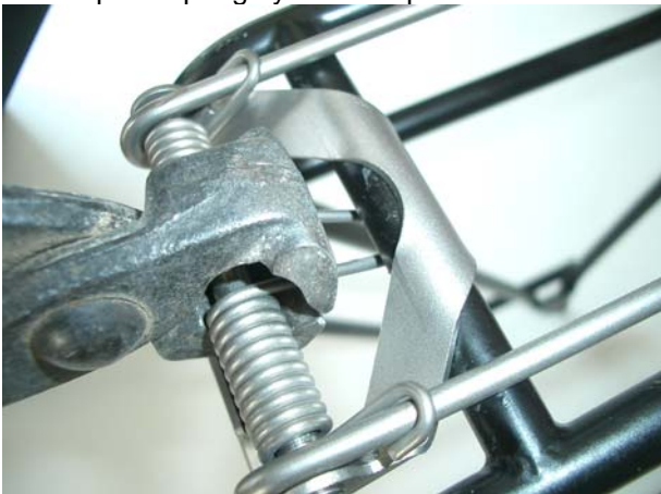
3. Blech mit der Rundung über die hintere Querstrebe stecken. Die Feder muß unter(!) der Strebe sein. 3. put the sheet metal with the round end over the rear cross-stay. The spring has to be below the stay !
