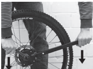
Figure 5: Serrage de la poulie arrière à l'aide de la clé à poulie POM et d'une clé plate SW24 pour le maintien de l'extracteur Rohloff
