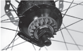
Figure 2: Bloquez l'extracteur Rohloff à l'aide du serrage rapide (CC) ou de l'écrou (TS)
