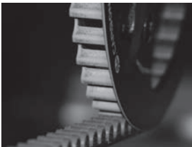
Figure 2: Usure rapide du revêtement bleuté employé au cours de fabrication de la courroie
