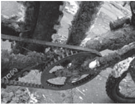
Figure 1: Même en présence de boue la courroie Carbon Drive reste relativement propre
