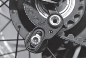
Afbeelding 3: Zijaanzicht van de gemonteerde snubber
