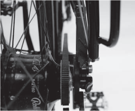
Afbeelding 3: correcte uitlijning van de riem
