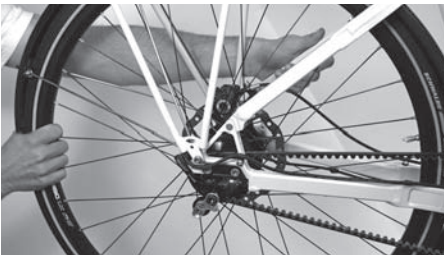
Afbeelding 3: correcte uitlijning van de riem
