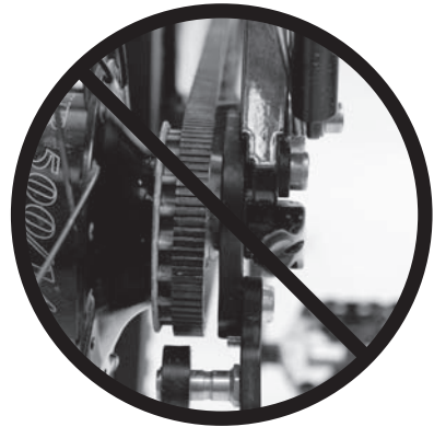
Afbeelding 4: onjuiste uitlijning van de riem
