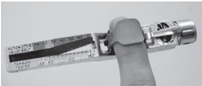
Fixeren van de Tension Tester (art.nr. 10400009)
